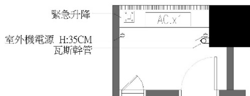
B2、B5(有升降裝置)左 空調室外機
